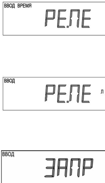
*Шаг 10S*– Используя кнопки « ВНИЗ» или « ВВЕРХ» установите вариант работы дополнительного релейного выхода:
