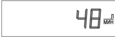
*Шаг 6D – Расход воды, максимальный за последние 7 дней*: На дисплее появится значение максимального расхода воды (л/мин), который был зафиксирован за последние 7 дней . На дисплее выводится «0» (ноль), если не установлен счетчик воды. Нажмите кнопку «ДАЛЕЕ» для выхода из режима «Диагностика». Нажмите кнопку «ПРОМЫВКА» для того, чтобы вернуться на предыдущий шаг.
