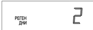
**Шаг 2D** – Число дней после последней регенерации: Выводиться число дней, прошедших со времени последней Регенерации.
