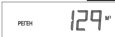
**Шаг 3D** – Объем воды (в м<sup>3</sup>) после последней регенерации: Выводится объем воды (в м<sup>3</sup>), очищенной со времени последней регенерации. Если водосчетчик не установлен, на дисплее будет высвечиваться «0».
