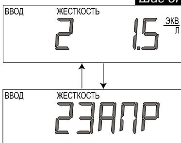
На дисплее будет выводиться значение «2 ЗАПР», если клапан установлен в режим *Фильтрация* на *Шаге 2F* или если в настройках "Последовательность стадий регенерации" на *Шаге 4CS* выбрали «М<sup>3</sup>».
