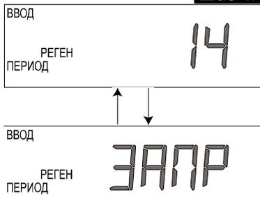
Если этот параметр установлен в положение « ЗАПР», Регенерация будет начинаться **только** по объему обработанной воды; если вводится число ( допустимый диапазон от 1до 28), регенерация начнется в установленный день, даже если установленный ресурс обработанной воды не был использован. Установите *День регенерации*, используя кнопки «ВНИЗ» или «ВВЕРХ»:
