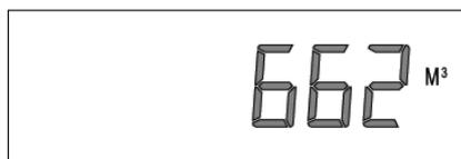
*Шаг 4VN* – *Общее количество воды (в м³), использованное с начала работы:* На дисплей выводится значение общего количества воды (в галлонах), которое было использовано с момента начала работы клапана. На дисплее выводится «0» (нуль), если не установлен счетчик воды.
