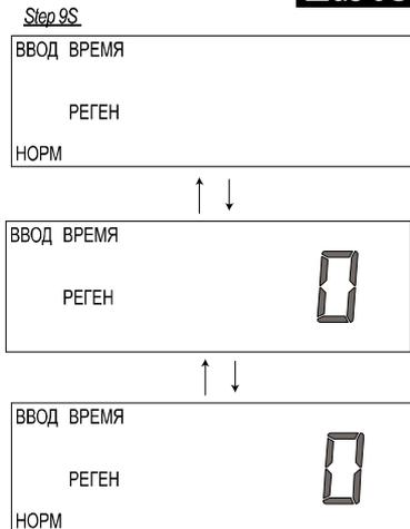
*Шаг 9S* – Установите параметр *Режим регенерации*, используя кнопки « ВНИЗ» или « ВВЕРХ» (на дисплее высвечиваются надписи «ВВОД», «ВРЕМЯ» и «РЕГЕН»):
