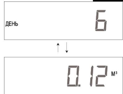
**Шаг 4D** –Резервный ресурс системы (в м<sup>3</sup>) за последние 7 дней: Если управляющий клапан настроен в качестве фильтра-умягчителя, установлен счетчик воды и параметр *Ресурс системы* в м<sup>3</sup> настроен на «РАСЧ», то на дисплее будет выводиться номер дня - «0» (текущий), а затем значение - Резервного ресурса воды (в м<sup>3</sup>) за этот день. Для того чтобы вывести значения использованного Резервного ресурса за другие бдней (вчера, позавчера и т.д.), удерживайте кнопку «ВВЕРХ».
